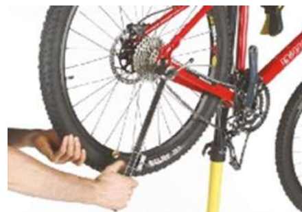
Figura 4. Alineación de la pata (hanger).
